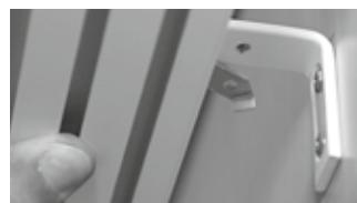
Deckenspanner am Wandwinkel montieren
