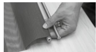
untere Beschwerung wird nur einseitig vormontiert, Beschwerungsprofil durch den Endlos-Behang schieben
