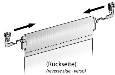
Steckhaken auf beiden Seiten in die Nut des Paneelprofils schieben
