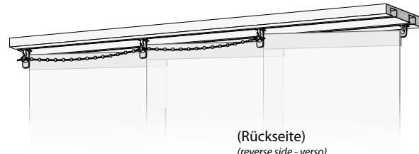
gekoppelte Paneelwagen mit einstellbarer Überlappung
