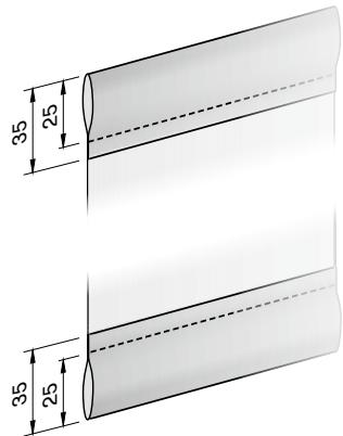
Zur Aufnahme des Beschwerungsprofils muss der untere Abschluss ebenfalls umsäumt werden.
