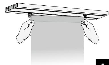
vormontiertes Stoffpaneel mit den Gleitern in je einen Lauf des Schienensystems einklicken und in den unteren Saum das Beschwerungsprofil einschieben
