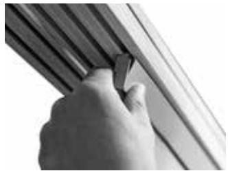
Paneel nach oben und danach nach unten drücken, sodass der Paneelwagen einrastet
