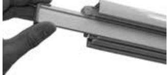
Paneelwagen seitlich in die Flächenvorhangsschiene einführen und Endkappe verschrauben
