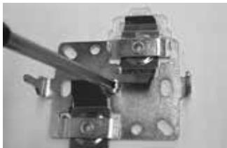
montieren Sie den Deckendoppelhalter
