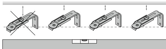
Zur Ausrichtung empfehlen wir die Nutzung einer Wasserwaage.
