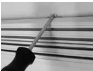
Die Demontage der Anlage erfolgt mittels Auslöseplatte. Verwenden Sie einen Schraubendreher und ziehen die Platte nach vorn. Die Schiene wird dadurch aus dem Deckenclip gelöst. Durch den entstandenen Raum lässt sich die übrige Schiene mittels Druck auf den Deckenclip einfach demontieren.
