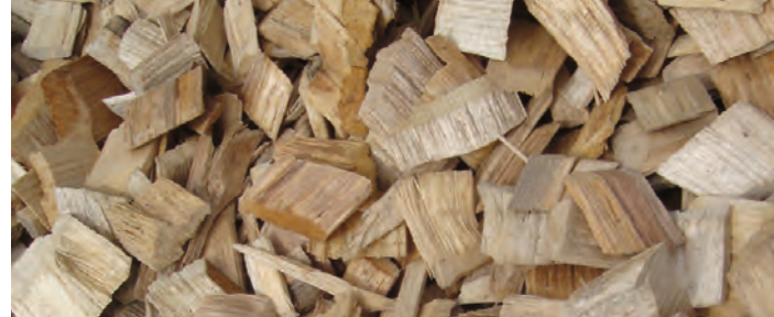
Umweltschonende und nachhaltige Beheizung der erfal Betriebsräume durch selbst erzeugte Hackschnitzel aus innerbetrieblich anfallenden Einwegpaletten und Holzverpackungen.
