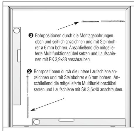
3 Bohrpositionen durch die Montagebohrungen oben und seitlich anzeichnen und mit Steinbohrer  $\varnothing$  6 mm bohren. Anschließend die mitgelieferte Multifunktionsdübel setzen und Laufschielen mit RK 3,9x38 anschrauben.
