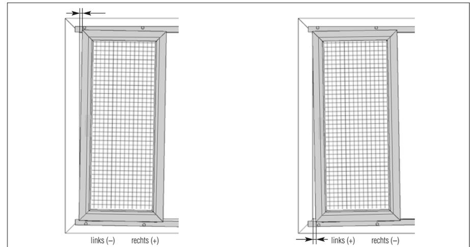
Durch Verschieben des Kunststoffrollenhalters in die (-) Richtung, wandert der Schiebeflügel auf dieser Seite um 1 mm nach unten.
