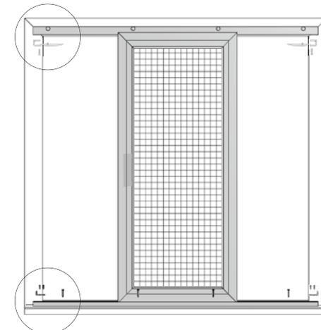
**1 Laufschiene Montagebohrungen**
