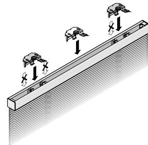
Träger positionieren, festschrauben
