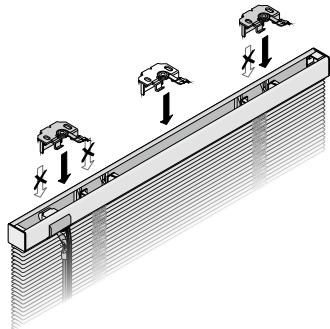
Träger positionieren, festschrauben
