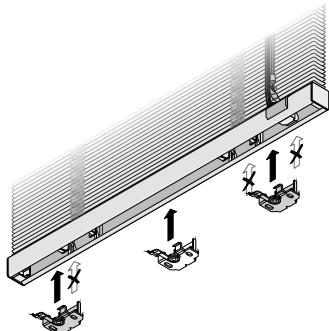
→ Träger NICHT im Bereich der Achsen montieren.
