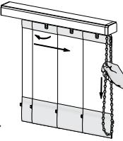
Durch Zug an der Bedienkette in die Gegenrichtung wenden die Lamellen. Der Behang öffnet sich.
