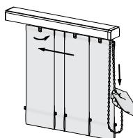
Durch Zug an der Bedienkette wenden die Lamellen komplett und fahren anschließend zu.
