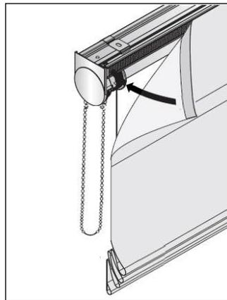
Schnurclip in Wickelspule einclicken und Behang mittels Flauschband am Klettprofil ankletten.
