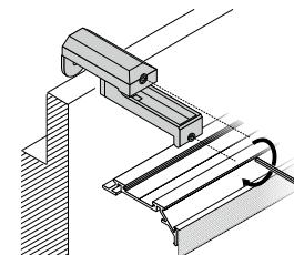
Trägerprofil in den Klemmträger einsetzen und mit Sechskantschlüssel festziehen. Danach Klemmträger auf den Fensterflügel setzen und mittels Sechskantschlüssel fixieren.
