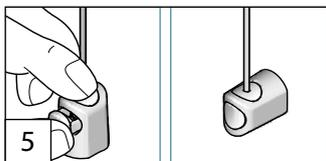
Rollo montieren, Seil durch Seilführung am Unterprofil ziehen
