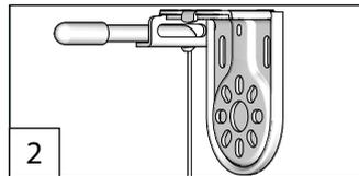
Seil durch das Schlitzloch ziehen; Kabelspanner zeigt nach unten (Deckenmontage) oder nach vorn (Wandmontage)
