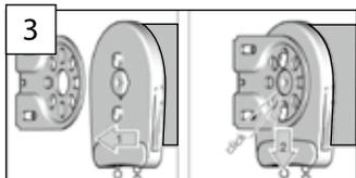
Kettengetriebe in Träger setzen (1);
