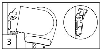
Trägerprofil an Unterseite des Clips anlegen
