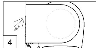
Trägerprofil in Clip einrasten
