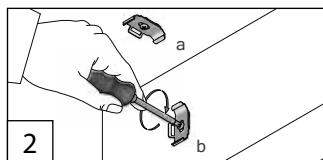
Halteclip befestigen an: a Decke; b Wand
