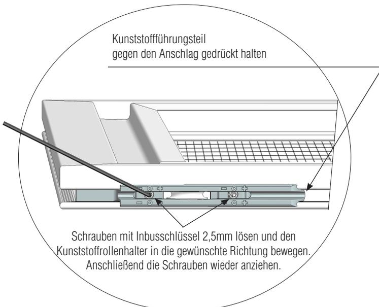
Schrauben mit Inbusschlüssel 2,5mm lösen und den Kunststoffrollenhalter in die gewünschte Richtung bewegen. Anschließend die Schrauben wieder anziehen.
