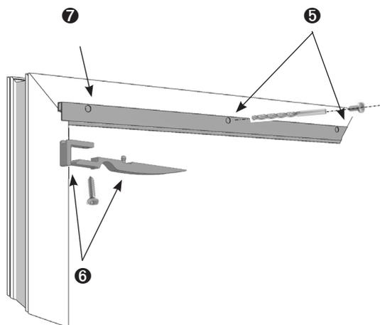
5 Oberkante Laufschiene nach den Markierungen ausrichten. Durch die Montagebohrungen vorbohren und mit RK 3,5x13 anschrauben. Abdeckkappen aufstecken.
