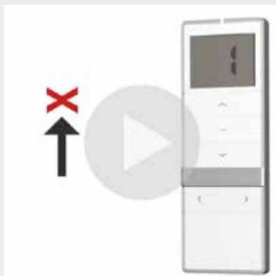
eACCU - Drehrichtung nach Programmierung ändern
