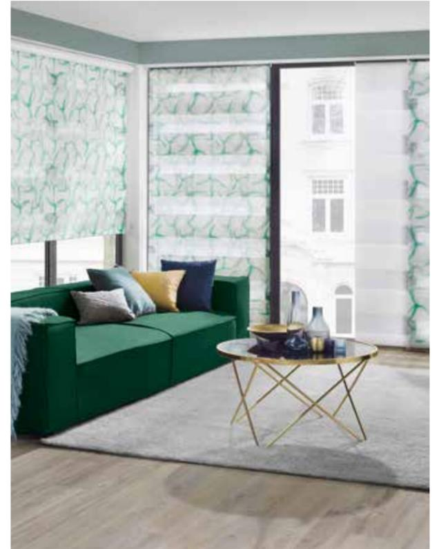
Besonderheit: Doppelrollo-Paneel, Sichtregulierung sowohl durch seitliches Verschieben des gesamten Paneels als auch durch die vertikale Positionierung der Streifen des Doppelrollostoffs.
