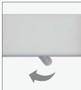
Schiene auflegen und Clip drehen
