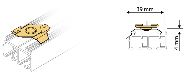
Schnellmontageclip mit Halteclip gekröpft für T-Profil 24–26 mm, nur geeignet für Schiene 7620 und 7630
