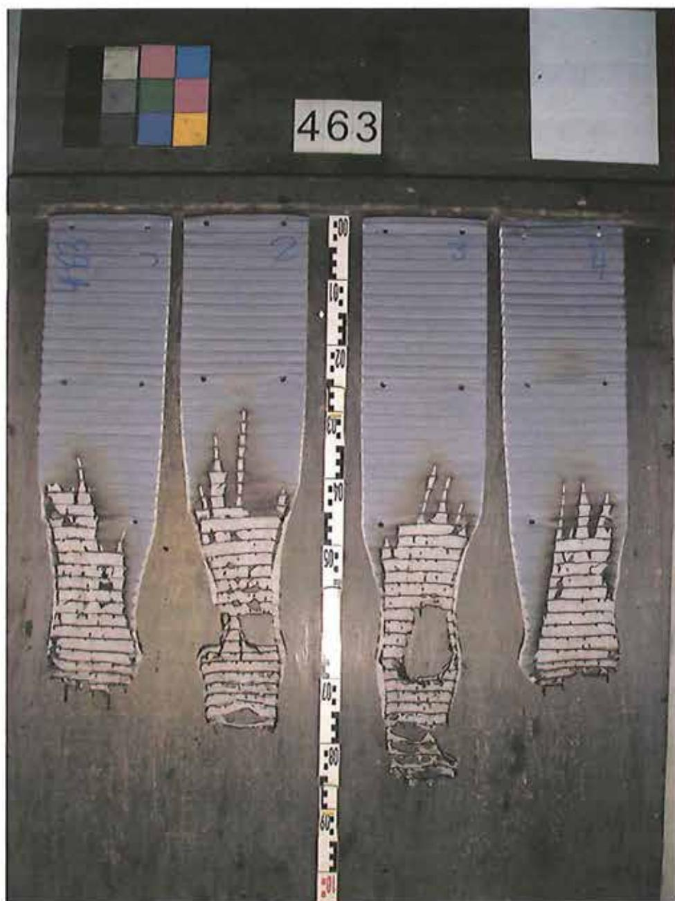
Bild 1: Aussehen des Probekörpers C nach dem Brandschachtversuch
