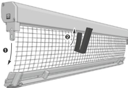
Rollokasten waagerecht und zum Blendrahmen ausrichten. Das Langloch anzeichnen, mit Steinbohrer  $\varnothing$  6 mm vorbohren, Dübel setzen und mit Schrauben SK 4,0 x 40 anschrauben. Waagerechte Position prüfen.
